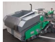
附加乳化沥青罐 对于用量大的承包商，附 加乳化沥青罐，使容量增 加5,000 l。
